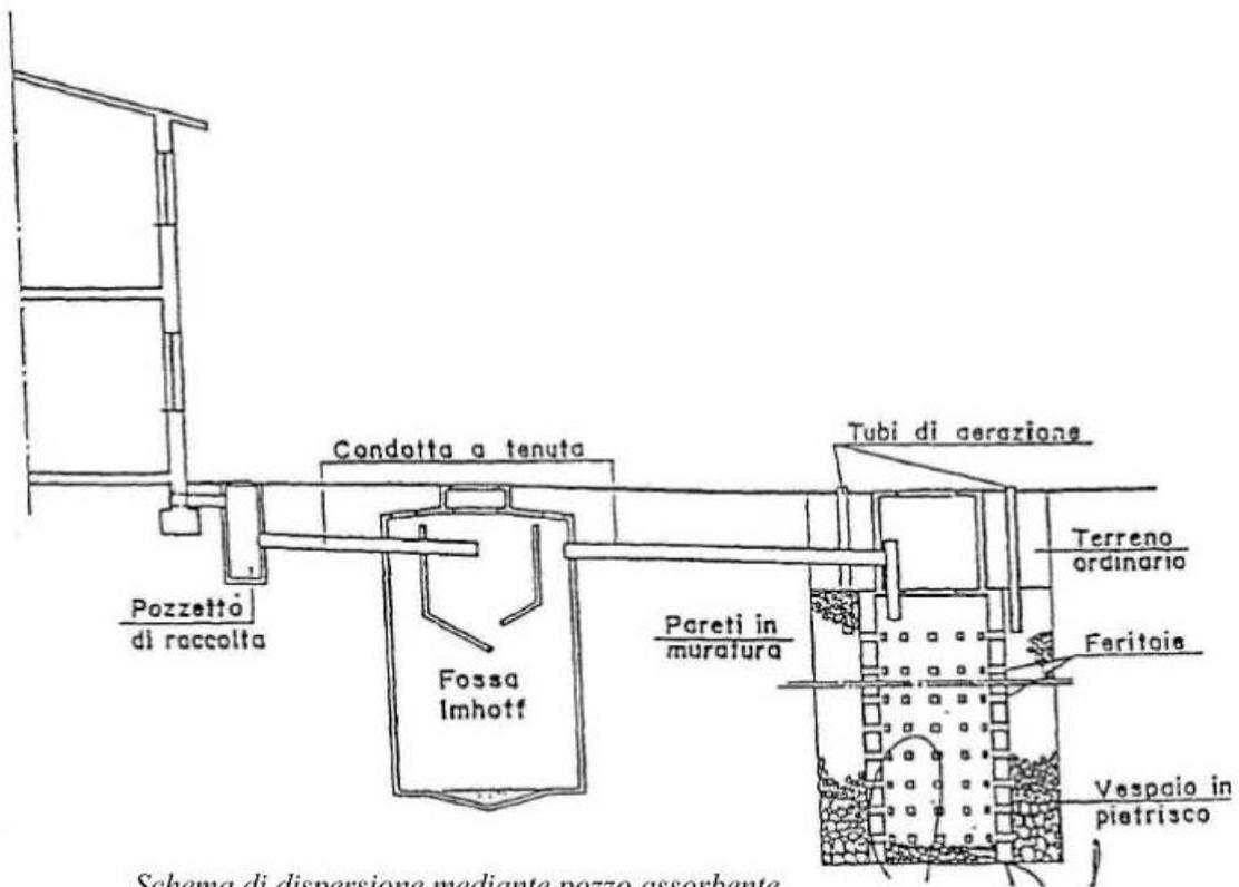
*Schema di dispersione mediante pozzo assorbente*
